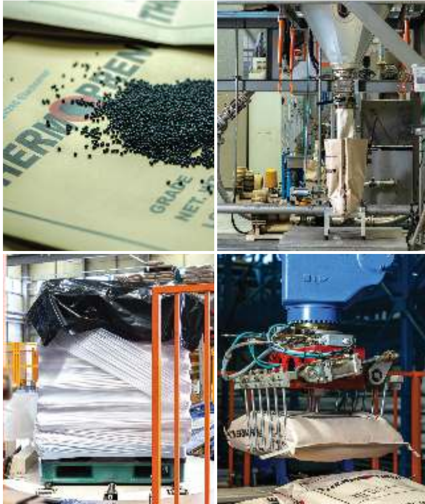
(왼쪽 상단부터 시계방향) 화승소재 명례공장의 자동화 공정 화승소재가 자체 개발한 TPE 브랜드, 'THERMOPRENE' 제품이 선별을 통해 봉투에 담긴 후 패키징에 이르는 과정
