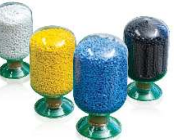
THERMOPRENE은 고무의 부드러운 감촉과 리사이클이 가능한 플라스틱의 특성을 고루 갖추고 있으며 용도와 색상에 따라 다양한 제품군을 이루고 있다.
